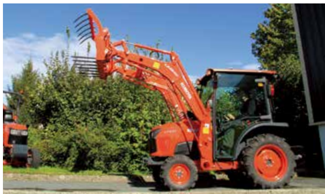
VOORLADERWERK MET TANDENBAK
